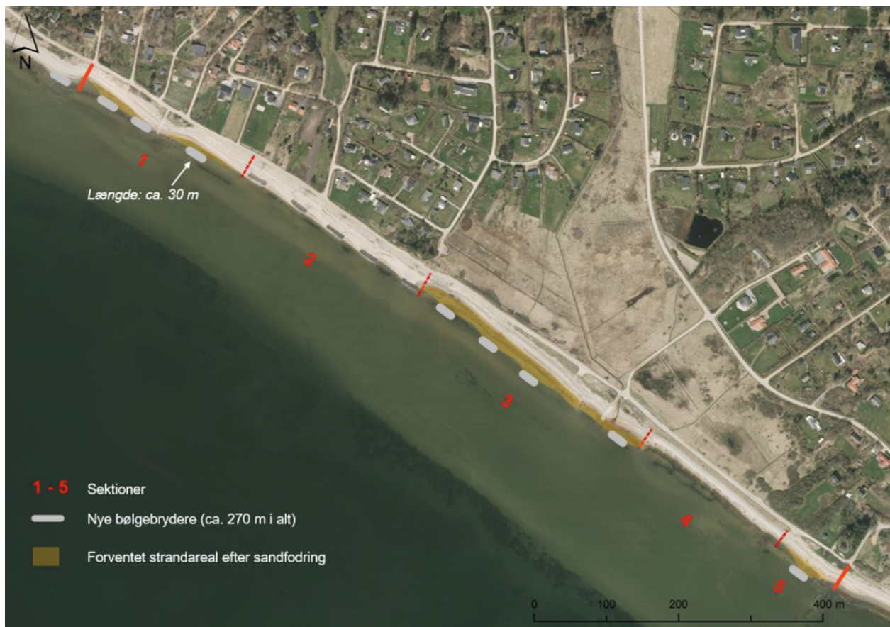
Projektets udformning med placering af nye bølgebrydere og områder m. forventet sandfodring.
